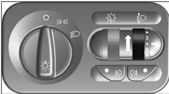
Позволяет при включенном ближнем свете фар корректировать угол наклона пучка света в зависимости от загрузки автобуса:
