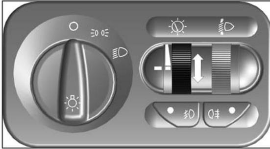
Поворотом регулятора вверх или вниз выбирается яркость освещения приборов, выключателей, пульта управления отоплением.
