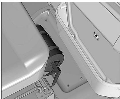
Автобус комплектуется огнетушителем ОП-2, который закреплен на накладке коврика пола слева от водителя.
